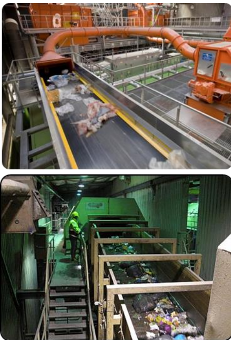
Figuur 6 Installaties voor bron- en nascheiding
